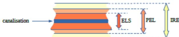
Les données présentées dans le tableau ci-après présentent les distances d'effets de part et d'autre de la ou des canalisation(s), générées par le scénario majorant (le plus souvent, rupture de la canalisation). Il convient donc de multiplier par 2 les distances affichées pour avoir la largeur totale de la zone de dangers correspondante.
